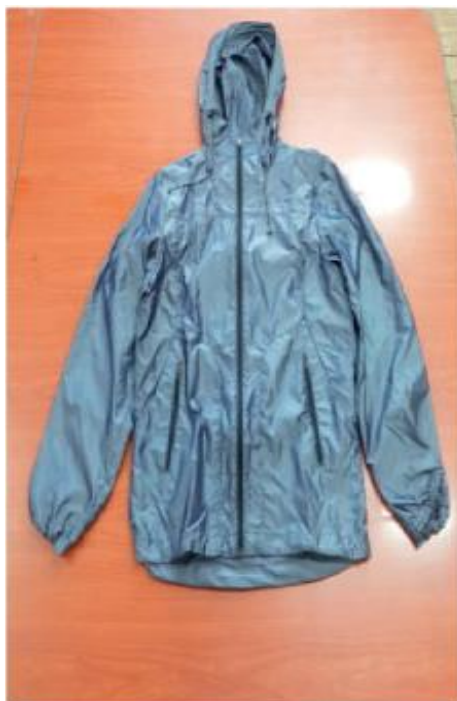
شکل ۲۱: نمونه‌ای از ژاکت تهیه‌شده از پارچه‌های جاسازی‌شده با زیرکونیوم‌کاربید - گرافیت.
